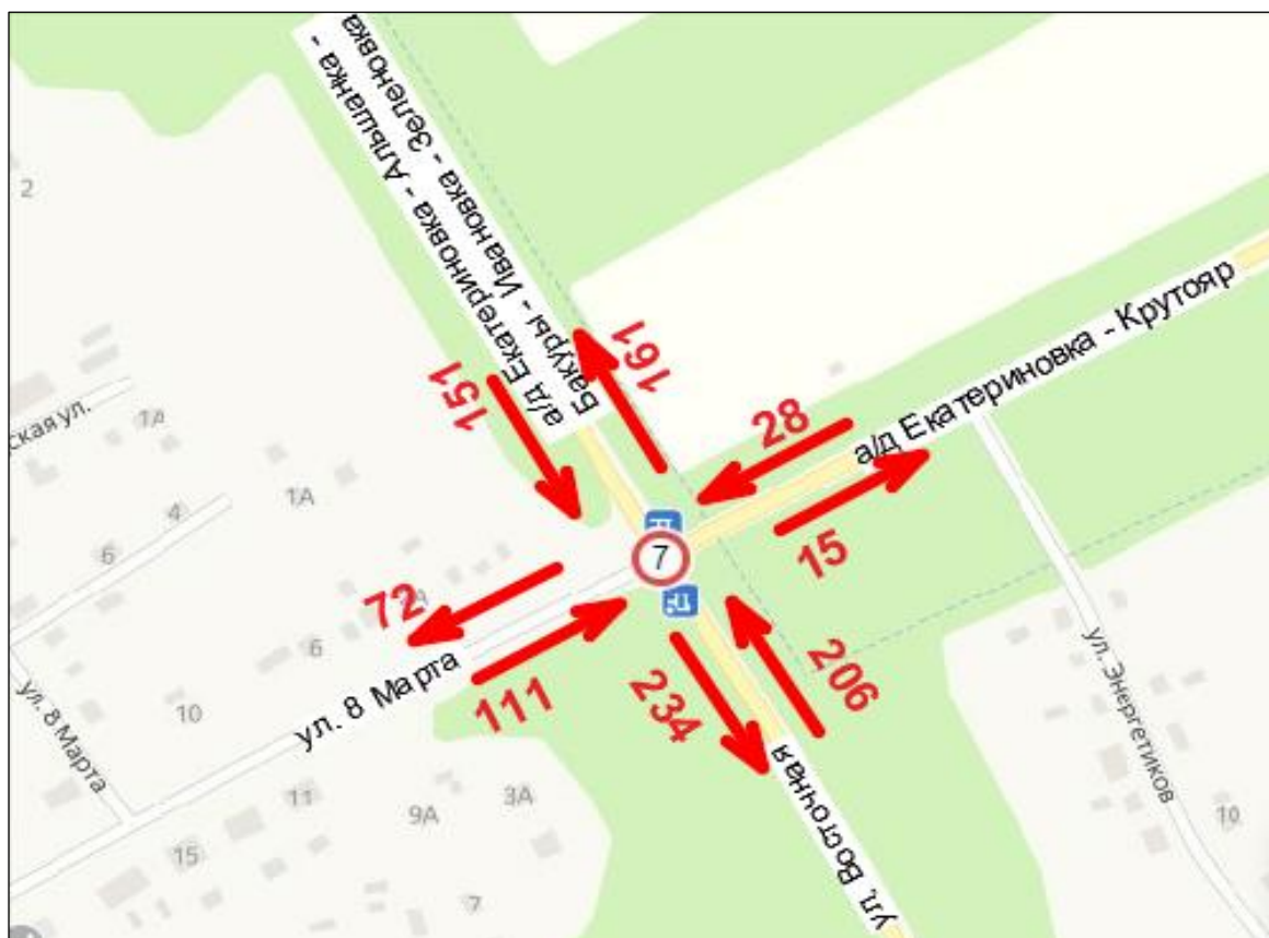
Рисунок 1.8.10 – Картограмма интенсивности движения в узле №7 а/д «Екатериновка-Альшанка-Бакуры-Ивановка-Зеленовка» - а/д «Екатериновка - Крутояр» - ул. 8 Марта, р.п. Екатериновка
