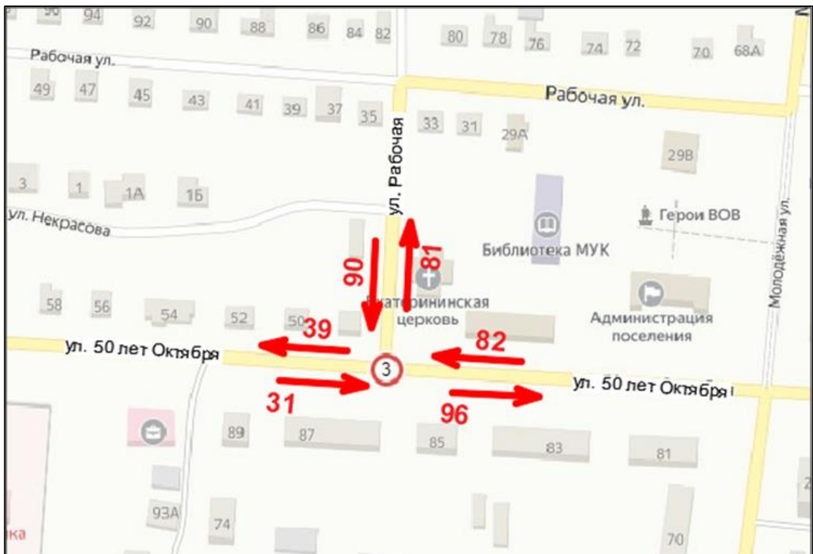
Рисунок 1.8.6 – Картограмма интенсивности движения в узле №3 ул. 50 лет Октября, р.п. Екатериновка – ул. Рабочая, р.п. Екатериновка
