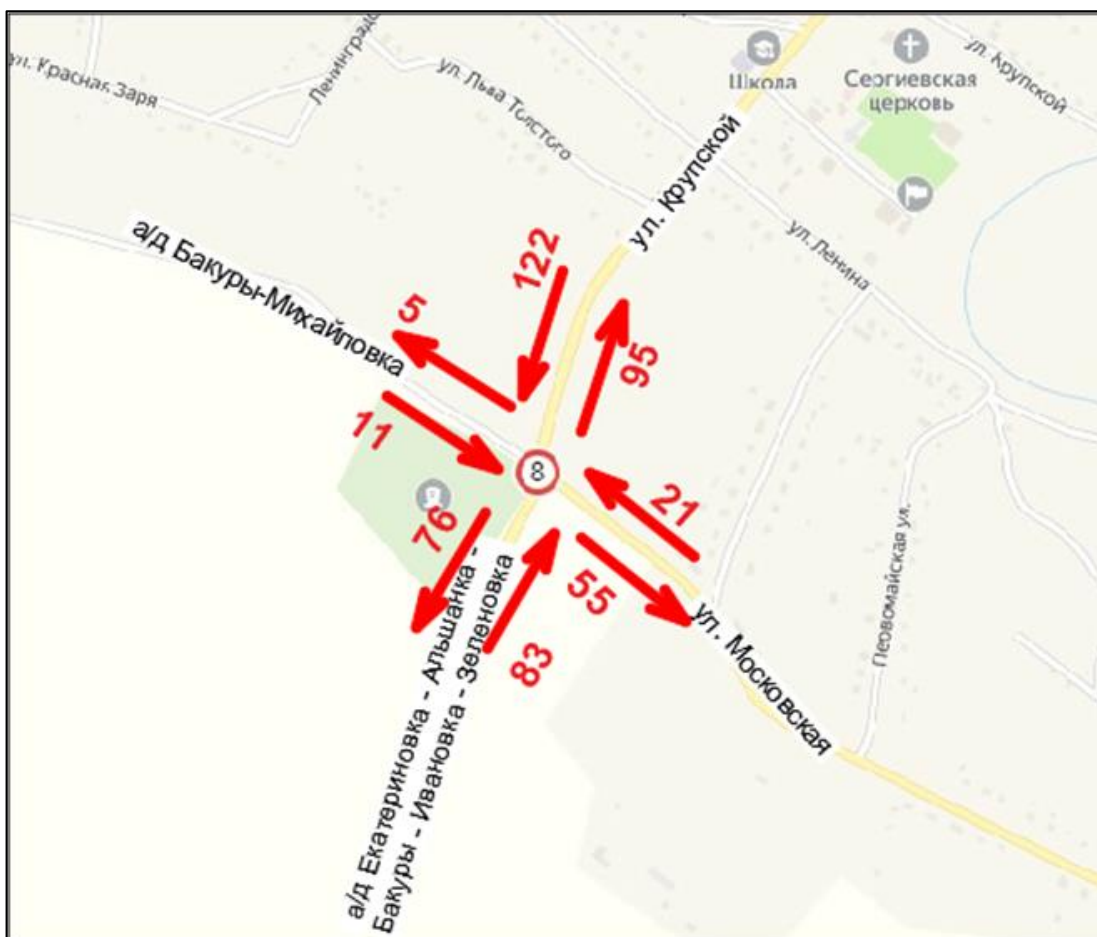
Рисунок 1.8.11 – Картограмма интенсивности движения в узле №8 а/д «Екатериновка-Альшанка-Бакуры-Ивановка-Зеленовка» - а/д «Бакуры-Михайловка» - ул. Московская, с. Бакуры
